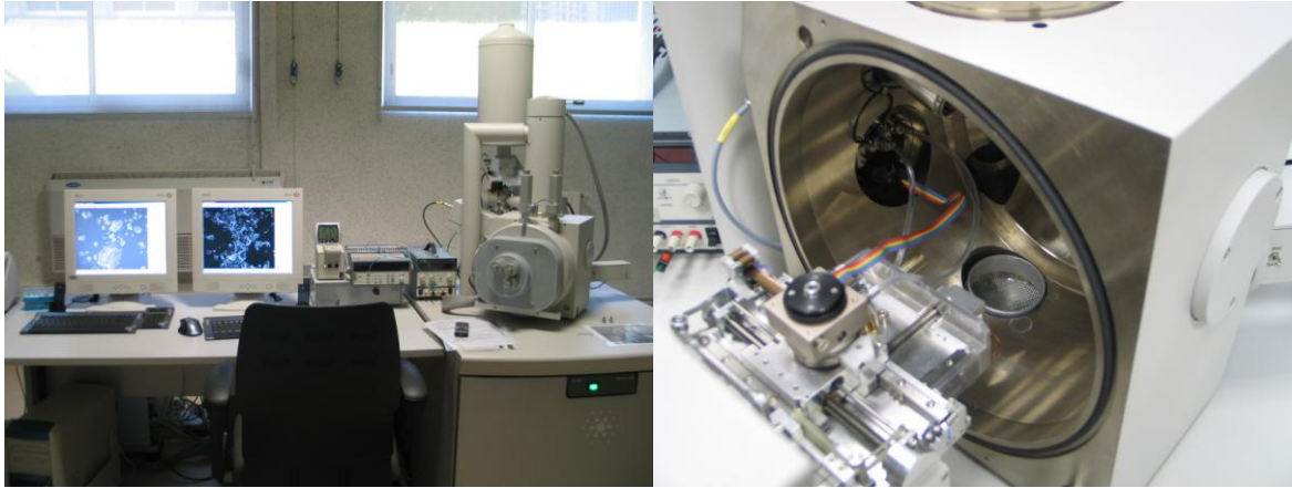
Figure 50: Photos du Microscope Electronique à Balayage Environnemental (MEBE): vue d'ensemble (à gauche) et vue de la chambre et d'un étage Peltier (à droite).
