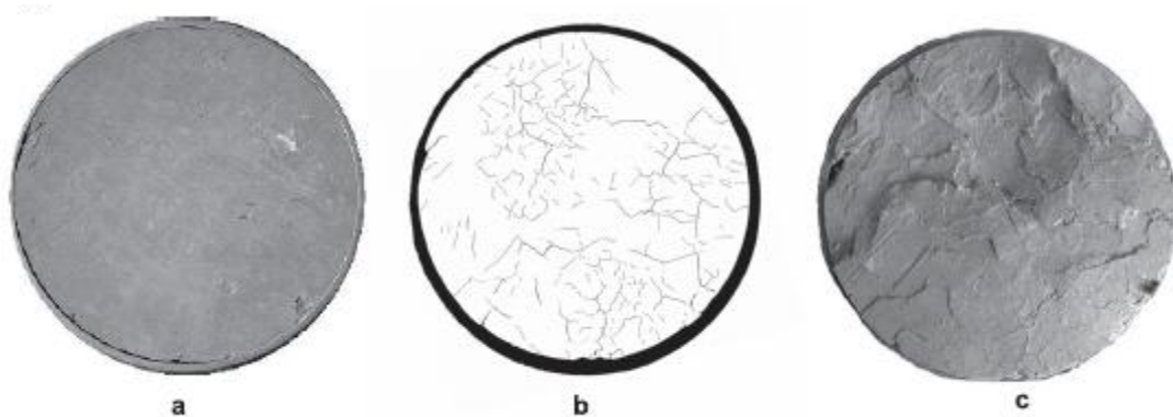
Figure 192: Argile verte de Romainville intacte; a) w=w_0 , b) visualisation du réseau de fissures après plusieurs cycles de séchage-humidification w < w_r , c) imbibition w > w_r ( w_0 : teneur en eau initiale; w_r : teneur en eau correspondant à la limite de retrait) (Audiguier et al., 2008)
