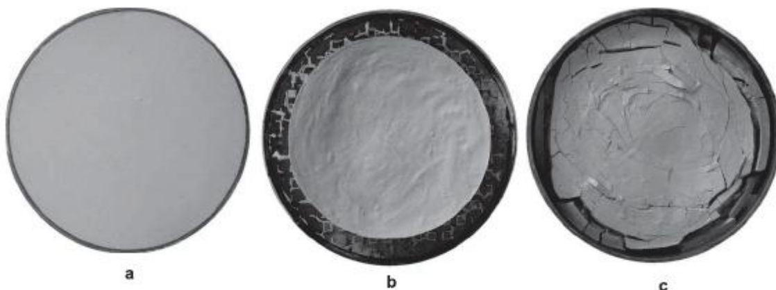
Figure 193: Argile verte de Romainville remaniée; a) w=w_0 , b) après séchage, c) imbibition w > w_r ( w_0 : teneur en eau initiale; w_r : teneur en eau correspondant à la limite de retrait) (Audiguier et al., 2008)
