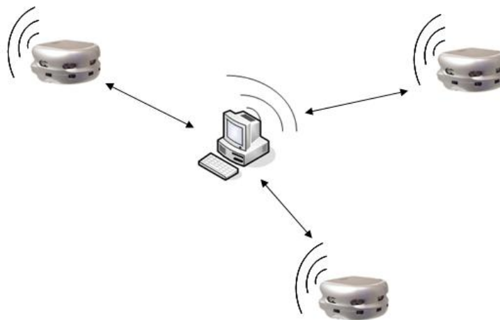
Figure B.5 – Mode de fonctionnement infrastructure
