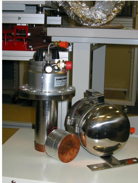
FIG. 1.16 – Doigt froid réfrigérant (ou pulse tube refrigerator, PTR)
