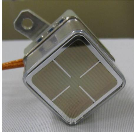
FIG. 1.14 – Photomultiplicateur Hamamatsu R7600-06MOD-ASSY utilisé dans la TPC au xénon liquide.
