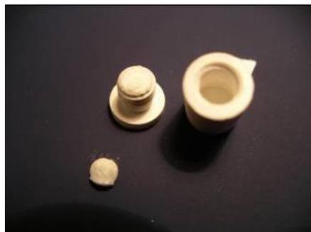
**Figure 3-15.** Aspect de l'échantillon après ouverture du creuset RMN (37%mol AlF<sub>3</sub>).
