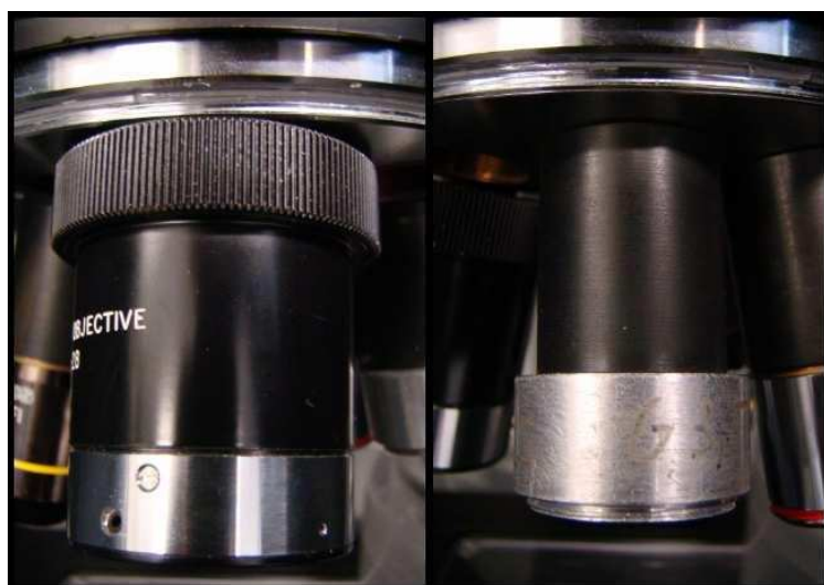
Figure II.8 : photographie des objectifs d'ablation. A gauche, l'objectif de type « Cassegrain » (x15). A droite, la lentille d'ablation (x4)
