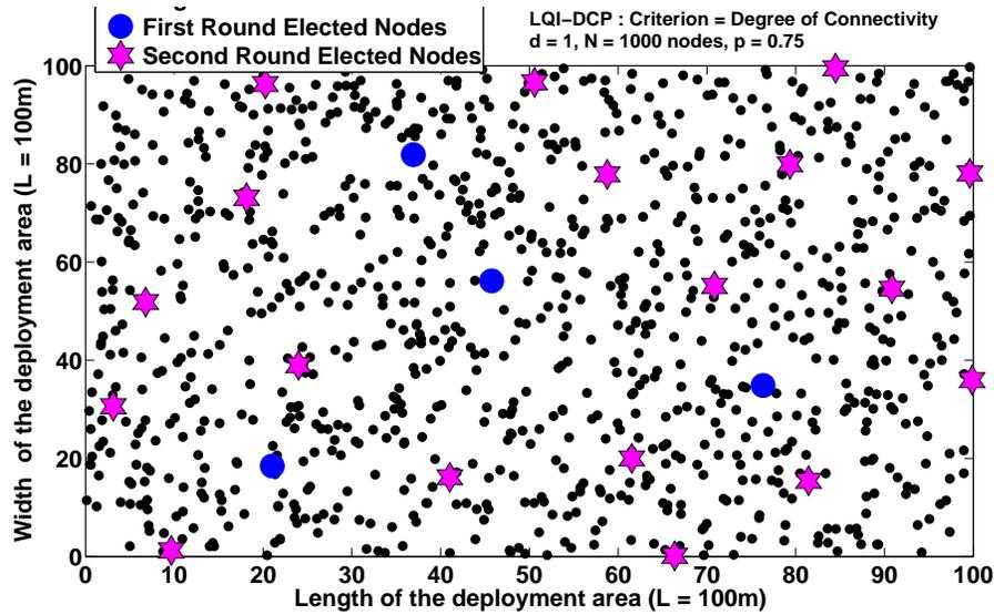
FIGURE 8.28: Positionnement moyen des caryommes (*LQI-DCP*, Degré de Connectivité,  $d = 1$ ,  $p = 0.75$ ) dans le cas des clusters uni-sauts. Les caryommes élus au 1<sup>er</sup> tour de *LQI-DCP* sont indiqués par un rond bleu, tandis que les caryommes issus du 2<sup>nd</sup> tour sont représentés par des étoiles.
