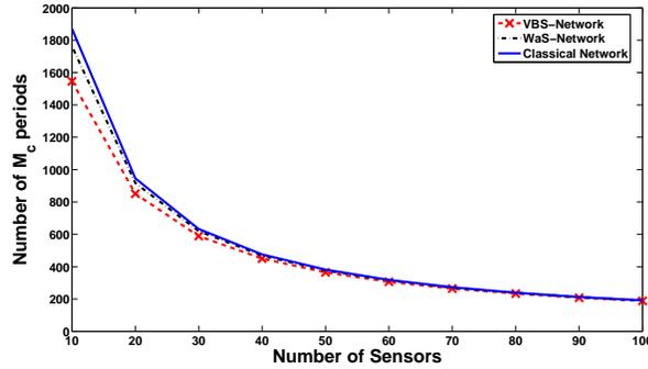
FIGURE 3.11: Evolution de la durée de vie moyenne de chacun des réseaux en termes du nombre de mandats de coordination ( $M_c$ ) vécus jusqu'au moment de la perte par épuisement de batteries du 1<sup>er</sup> capteur.
