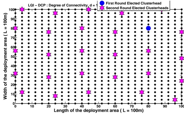
FIGURE 8.16: *Topologie de déploiement en grille : Positions moyennes des caryommes (LQI-DCP, Degré de Connectivité,  $d = 1$ ). Pour  $R = 20m$ , ce résultat montre que le positionnement des caryommes par LQI-DCP est d'une efficacité remarquable. Il n'y a qu'un seul caryomme élu dès le premier tour.*
