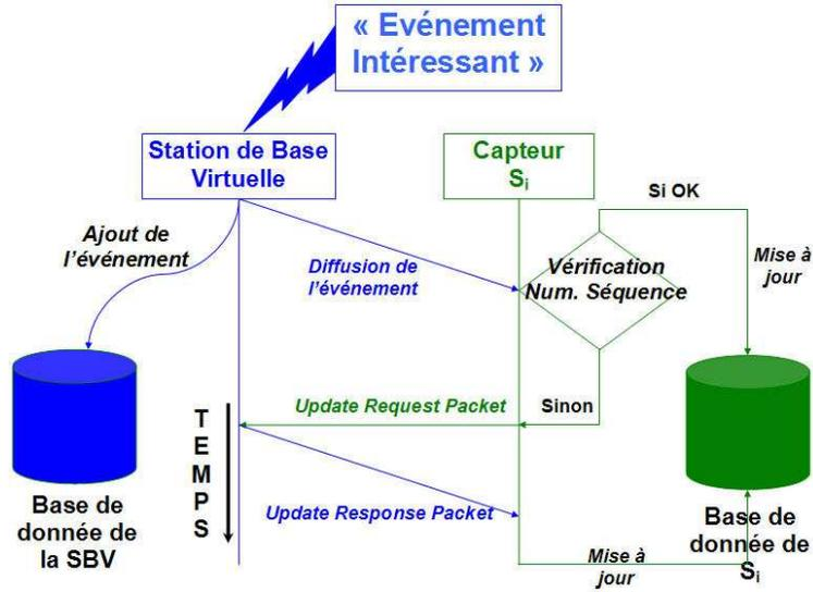
FIGURE 3.7: *Processus de mises à jour et de répliquions des bases d'événements des capteurs avec la SBV*
