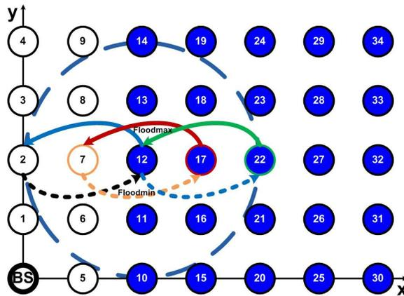
FIGURE 6.18: Conséquences du cas pathologique de *MaxMin* sur la topologie de réseau en grille : avec  $R = 2 * pas$ , à partir de la 3<sup>ème</sup> colonne, tous les nœuds sont élus caryommes.
