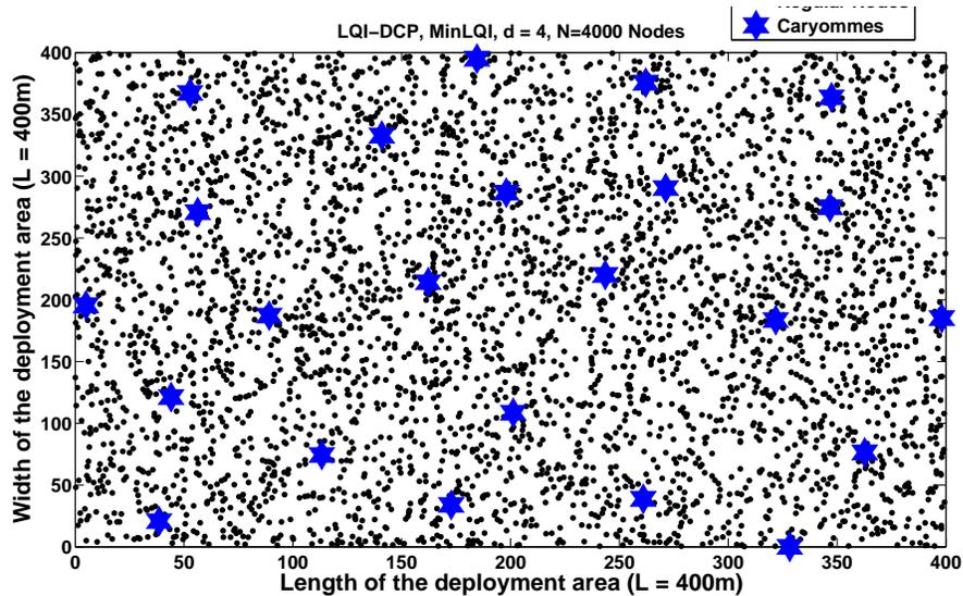
FIGURE 8.33: Positionnement moyen des caryommes (*LQI-DCP*, *MinLQI*,  $N = 4000$  Nœuds,  $R = 20m$ ,  $p = 0.75$ ) dans le cas des clusters multi-sauts avec  $d = 4$ . C'est le même réseau que pour *MaxMin* [Fig. 8.32] pour lequel la perturbation des liens n'est pas prise en compte ( $p = 0$ ).
