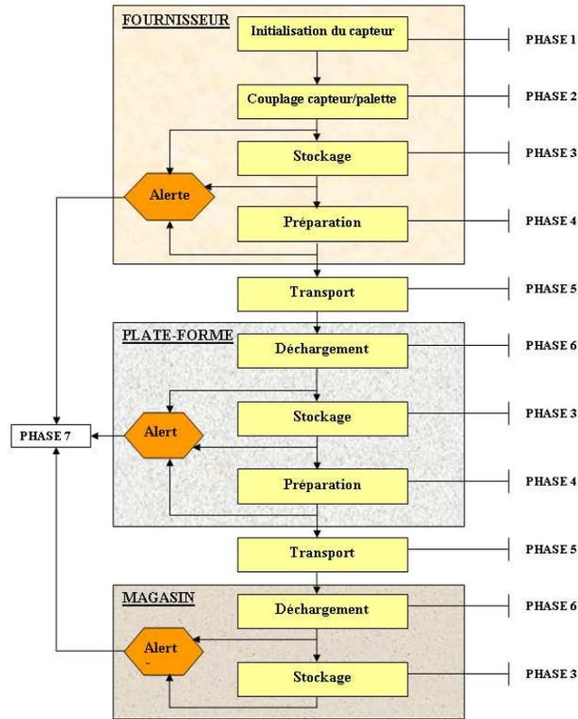
FIGURE 1.10: Opérations effectuées sur une chaîne logistique
