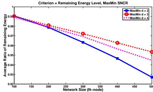
FIGURE 6.24: Taux moyen d'énergie restante après la formation des clusters par *MaxMin* utilisé avec le mécanisme de réduction des clusters singletons pour le critère « Niveau d'énergie restante », en faisant varier le paramètre  $d = 2 - 4$
