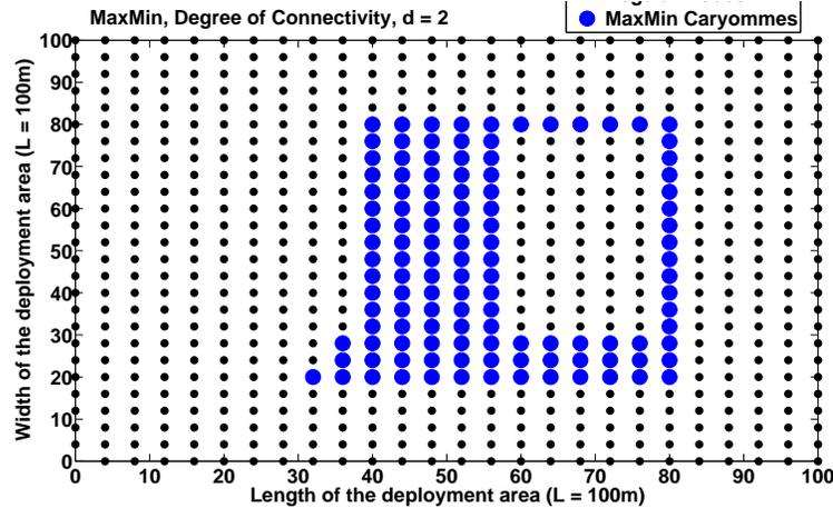
FIGURE 8.17: *Topologie de déploiement en grille : Positions moyennes des caryommes (MaxMin, Degré de Connectivité,  $d = 2$ ). Les effets du cas pathologique de MaxMin pèsent encore dans le cas des clusters multi-sauts ( $d \geq 2$ )*
