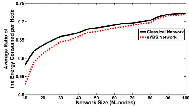
FIGURE 3.13: *Taux moyen d'énergie consommée par capteur jusqu'au moment de la perte du premier capteur par épuisement de batterie*
