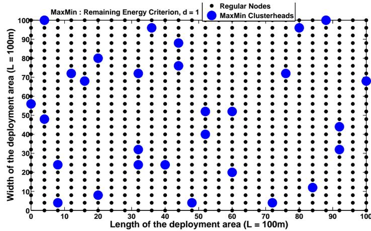
FIGURE 8.19: *Topologie de déploiement en grille : Positions moyennes des caryommes (MaxMin, Remaining Energy Criterion,  $d = 1$ ). Même en randomisant le critère de sélection des caryommes, MaxMin produit des positions de caryommes parfois trop rapprochées.*
