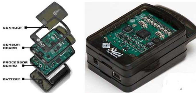
(a) *Composants Sun-*(b) *Capteur Sun-SPOT**SPOT*FIGURE 1.3: *Solutions Sun-SPOT*
