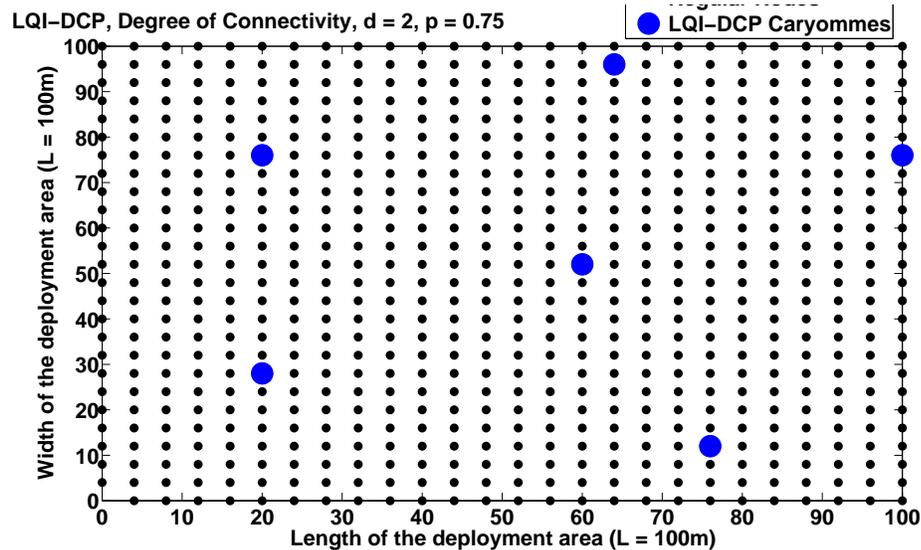
FIGURE 8.29: Positionnement moyen des caryommes (*LQI-DCP*, Degré de Connectivité,  $R = 20m$ ,  $p = 0.75$ ) dans le cas des clusters multi-sauts avec  $d = 2$  et de la topologie de réseau en grille. Ce résultat est remarquable, car pour  $R = 20m$  et  $d = 2$ , la perturbation ( $p = 0.75$ ) des liens est sans effet pour *LQI-DCP*.
