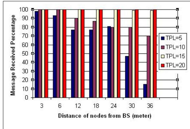
FIGURE 4.7: Réseau hétérogène ( $TPL = 31$  pour BS,  $TPL < 31$  pour les autres capteurs) : Variation du pourcentage des messages reçus (MRP) en fonction de l'éloignement du nœud vis-à-vis de la Station de Base
