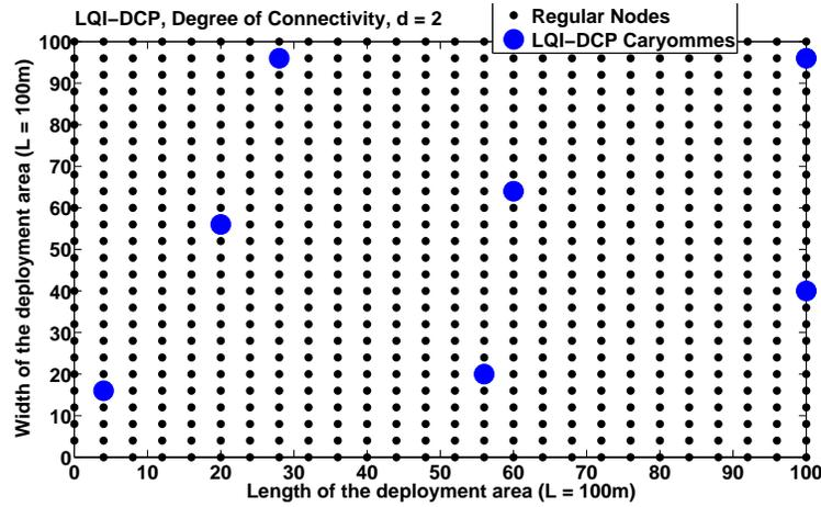
FIGURE 8.18: *Topologie de déploiement en grille : Positions moyennes des caryommes (LQI-DCP, Degré de Connectivité,  $d = 2$ ). Avec  $R = 20m$ , on voit sur cette figure que tout nœud est, au plus, en 2 sauts d'un caryomme.*
