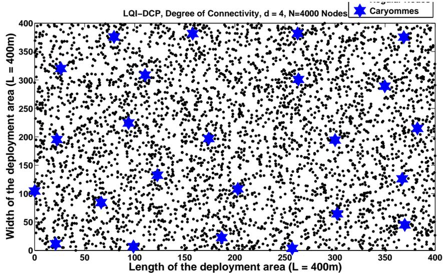
FIGURE 8.31: Positionnement moyen des caryommes (*LQI-DCP*, Degré de Connectivité,  $N = 4000$  Nœuds,  $R = 20m$ ,  $p = 0.75$ ) dans le cas des clusters multi-sauts avec  $d = 4$ . C'est le même réseau que pour *MaxMin* [Fig. 8.30] pour lequel la perturbation des liens n'est pas prise en compte ( $p = 0$ ).
