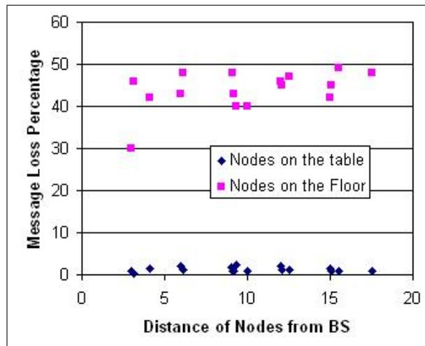
FIGURE 4.8: Comparaison du pourcentage de messages perdus dans le cas du déploiement à ras le sol, par rapport au déploiement en hauteur sur une table.  $TPL = 3$  pour BS et  $TPL = 10$  pour les autres capteurs
