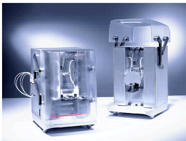
Figure IV - 9 : Zétamètre utilisé pour effectuer les mesures de potentiel d’écoulement
