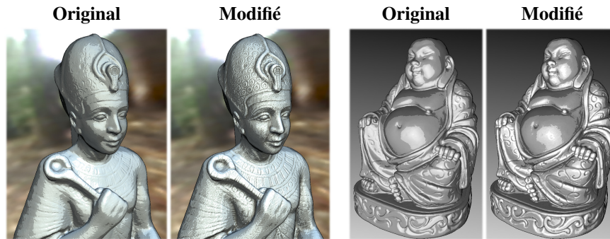
FIG. 5.13: À gauche : un environnement naturel est utilisé pour rendre l'objet avant de quantifier les couleurs. La texture de la surface et les cavités sont mises en valeur après application de notre méthode. À droite : même avec un environnement minimaliste, composé d'un simple gradient du noir au blanc ici, notre méthode permet de révéler les détails de surface.
