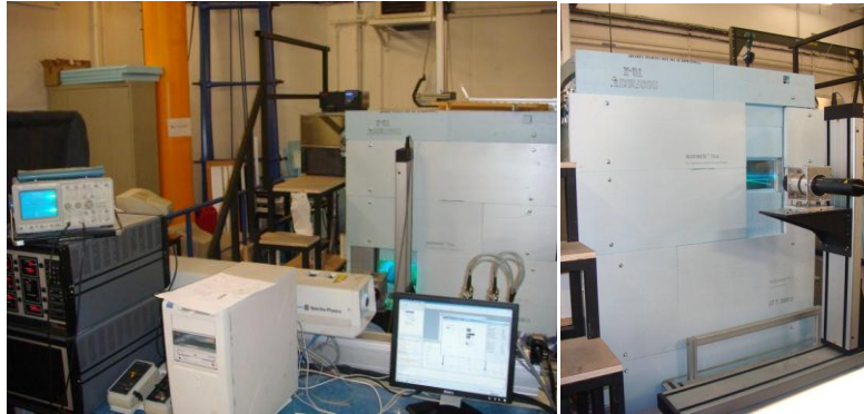
Figure 2.3-1 : Vue de la cavité instrumentée avec la LDV 2D.
