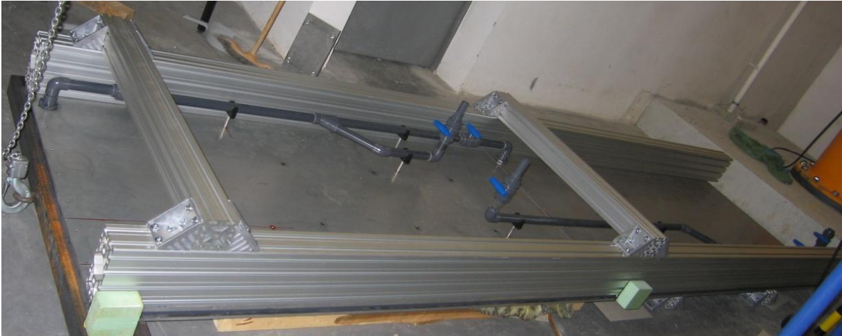
Figure 2.2-3 : Photographie de la face externe d'une paroi avant son installation avec les profilés et la tuyauterie.
