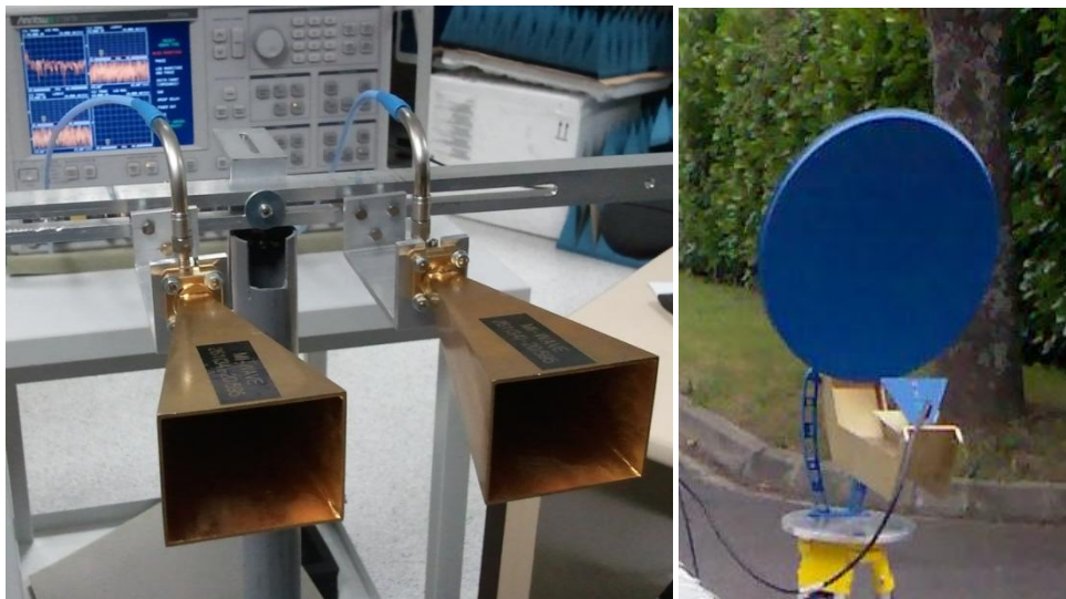
II-20 : (a) Antennes cornets ; (b) parabole
