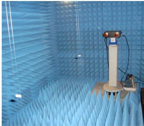
*IV-11 : Configuration de mesures des deux cibles de  $2\text{cm}^2$*
