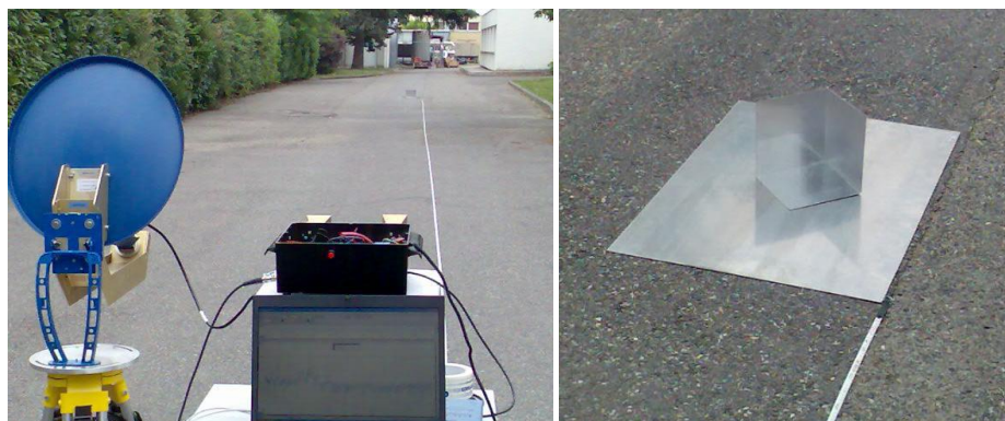
Figure III-12: Réflecteur positionné à 30m du radar
