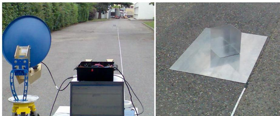
*Figure III-12: Réflecteur positionné à 30m du radar*
