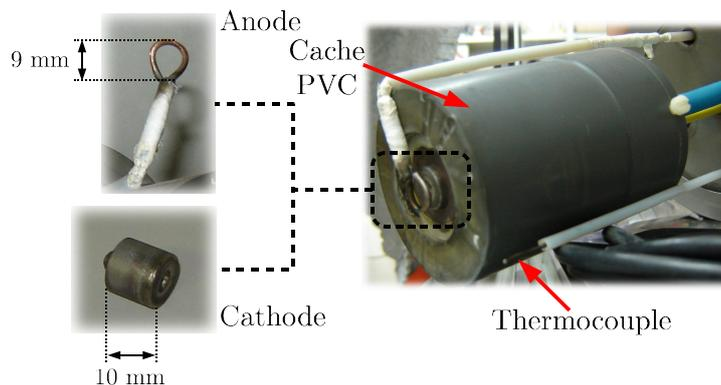
**FIGURE II.4** – Gros plan de la source au niveau de la cathode et de l’anode. Un cache en PVC recouvre le système de refroidissement en cuivre pour isoler et éviter que la décharge ne s’établisse ailleurs que sur la cathode en nickel.
