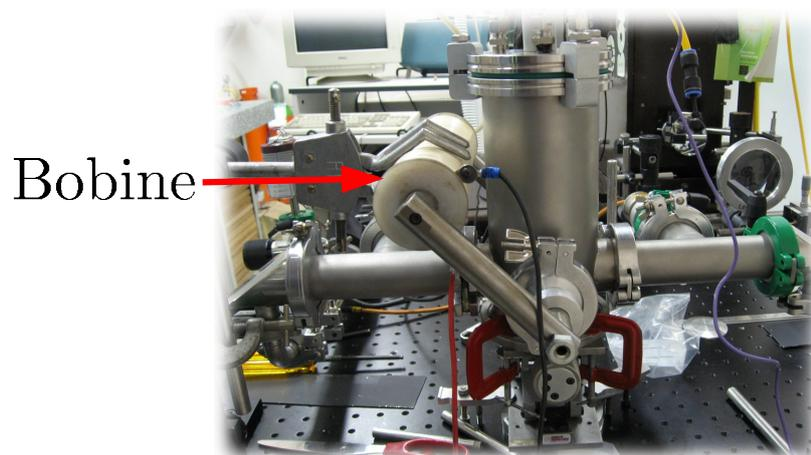
FIGURE II.6 – Photo du circuit électromagnétique avec la bobine montée sur la source à gauche de la photo. La bobine est reliée à une alimentation. Pour un courant de 1 A on obtient un champ magnétique de 0.14 T.
