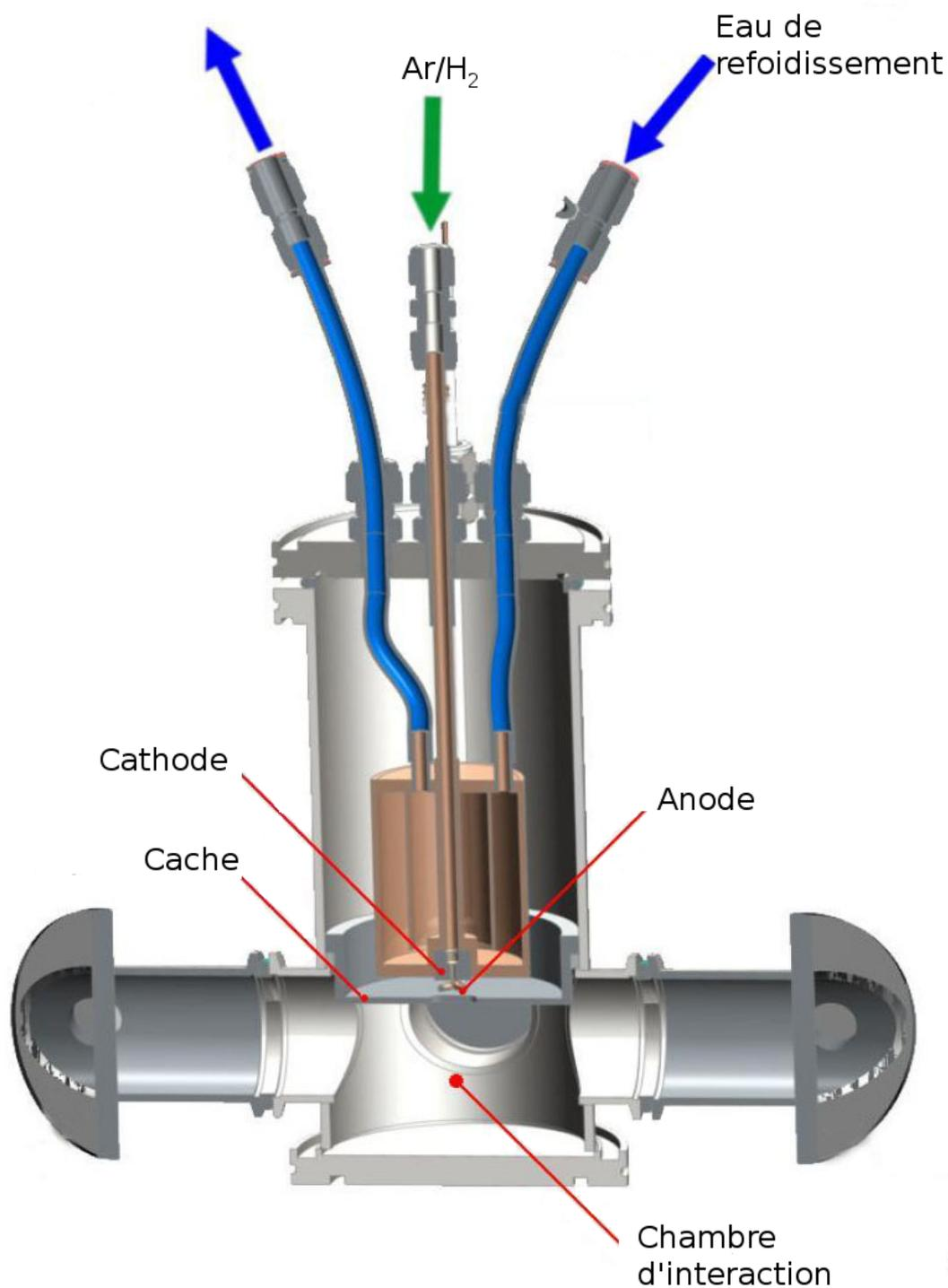
**FIGURE II.3** – Schéma représentant la source à pulvérisation cathodique avec refroidissement par eau. Cette source a été développée au LASIM lors des travaux de thèse de Raphaël Vallon. La chambre d'interaction est l'espace post-décharge ainsi que le lieu de l'incidence avec le faisceau laser. Elle est surplombée d'un cache dans lequel a été percé un trou qui laisse passer les radicaux NiH produits.
