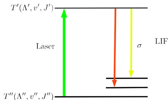
FIGURE II.11 – Principe de la spectroscopie LIF dispersée.
