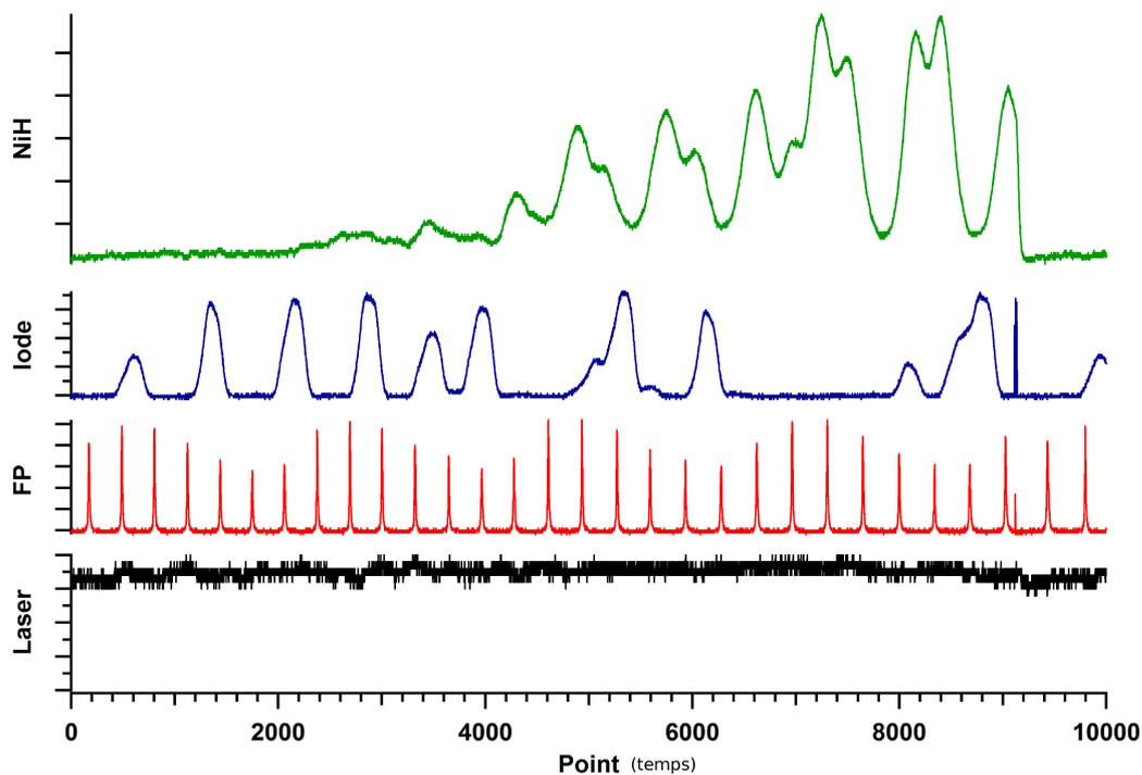
**FIGURE II.17** – Spectre d'excitation de NiH soumis à un champ magnétique ( $\approx 17408\text{--}17409\text{ cm}^{-1}$ ). Le spectre de l'iode, les pics de l'étalon Fabry-Pérot sont enregistrés pour la calibration. La puissance laser est enregistrée pour corriger des fluctuations en intensité qui affectent la ligne de base du spectre. La puissance du laser varie typiquement de 5% sur  $1\text{ cm}^{-1}$  de balayage.
