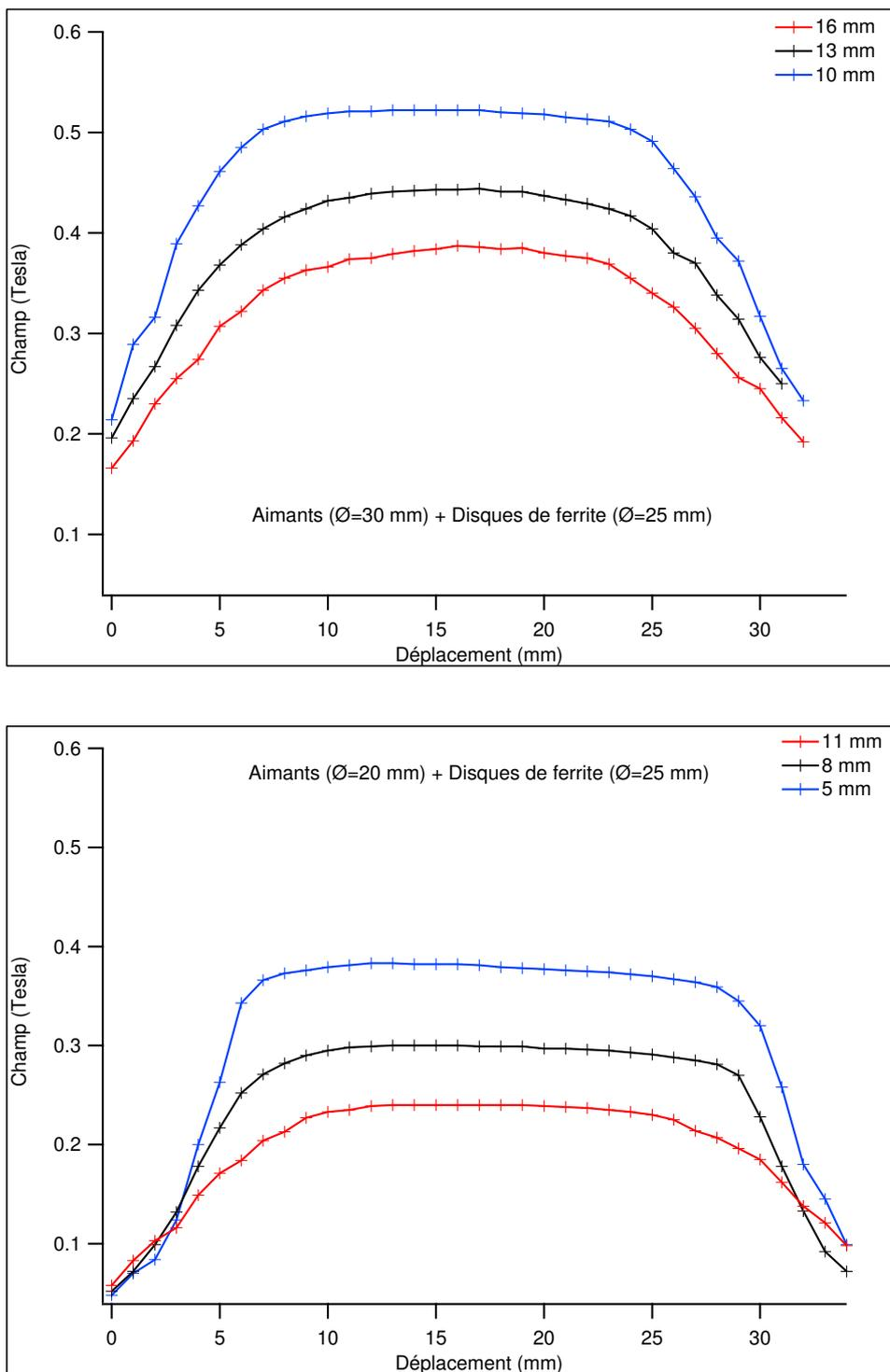
**FIGURE II.9** – *Champ magnétique exprimé en fonction du déplacement transverse de la sonde de Hall. Le centre des courbes correspond au centre de l'entrefer. Les 2 jeux de courbes ont été réalisés avec les aimants recouverts du disque de ferrite. Le relevé de champ du haut a été fait avec les aimants de 30 mm de diamètre alors que celui du bas avec des aimants de diamètre de 2 cm.*
