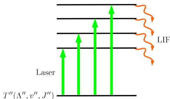
FIGURE II.15 – Principe de la spectroscopie LIF en excitation.
