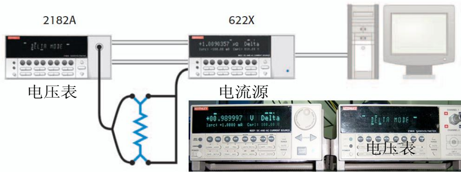
图 5-8. 电学测量系统工作原理与实物照片。
