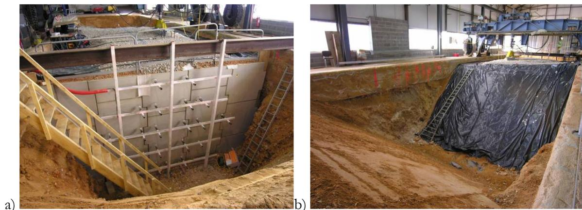
Figure 2-1 - Insertion du plot expérimental dans la fosse d'essais : a) vue côté parement, b) vue côté remblai technique.
