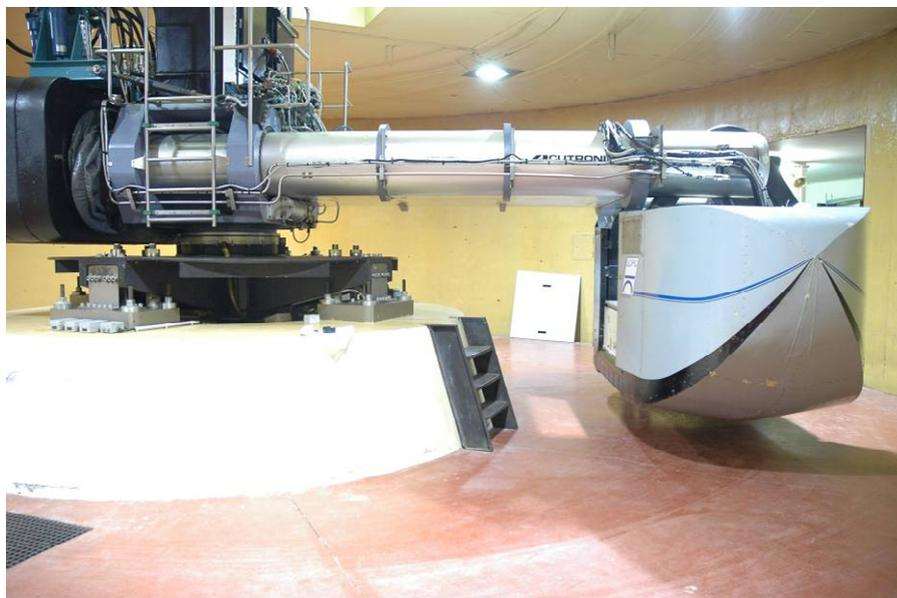
Figure 6-1 - Centrifugeuse géotechnique du LCPC
