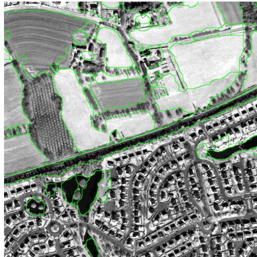
FIGURE 11.4 – **Segmentation à plus basse résolution.** La segmentation a été réalisée à partir d'une décomposition en ondelettes de 3 niveaux
