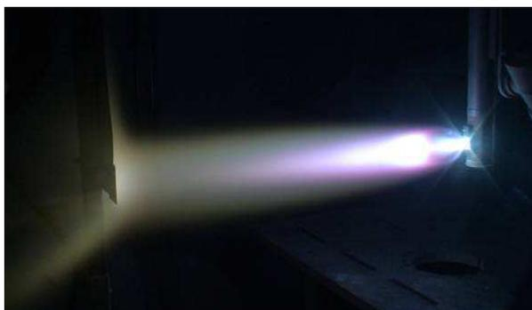
Figure IV.29 : Photographie d'une projection VLPPS avec la torche F100 en injection axiale de poudre
