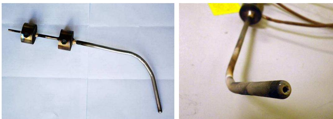
Figure III.15: a) Sonde enthalpique sans revêtement et b) Tête de la sonde avec un revêtement de Ni/Al et ZrO<sub>2</sub>+ Y<sub>2</sub>O<sub>3</sub>
