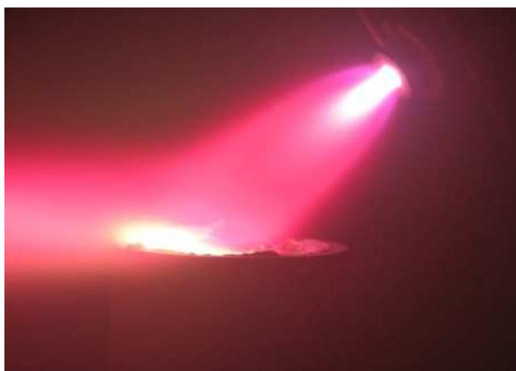
Figure IV.23: Chauffage d'un barreau de cuivre par jet plasma
