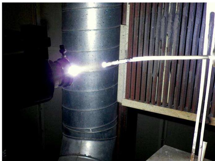
Figure III.16 : Photographie de la sonde en condition de projection APS avec la nouvelle sonde
