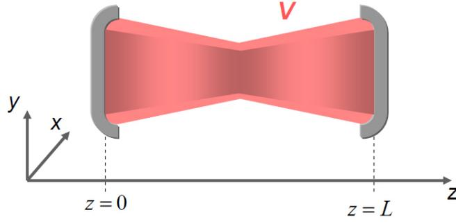
**Figure 1.1:** Cavité optique en résonance avec le champ électromagnétique contenu entre ses deux miroirs parfaitement réfléchissants : le champ électromagnétique est alors nul à leurs surfaces en  $z = 0$  et  $z = L$ . La cavité délimite un volume de quantification arbitraire  $V$  (en rouge) pour le champ électromagnétique.
