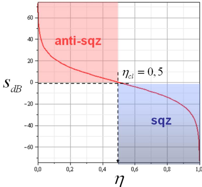
**Figure 4.5:** Évolution de la compression (en échelle logarithmique) de l'état rétrodicté d'une détection homodyne avec son efficacité de détection  $\eta$ .— La compression (sqz) de cet état est perdue à des efficacités  $\eta < 0.5$  pour lesquelles l'état rétrodicté est anti-comprimé (anti-sqz).
