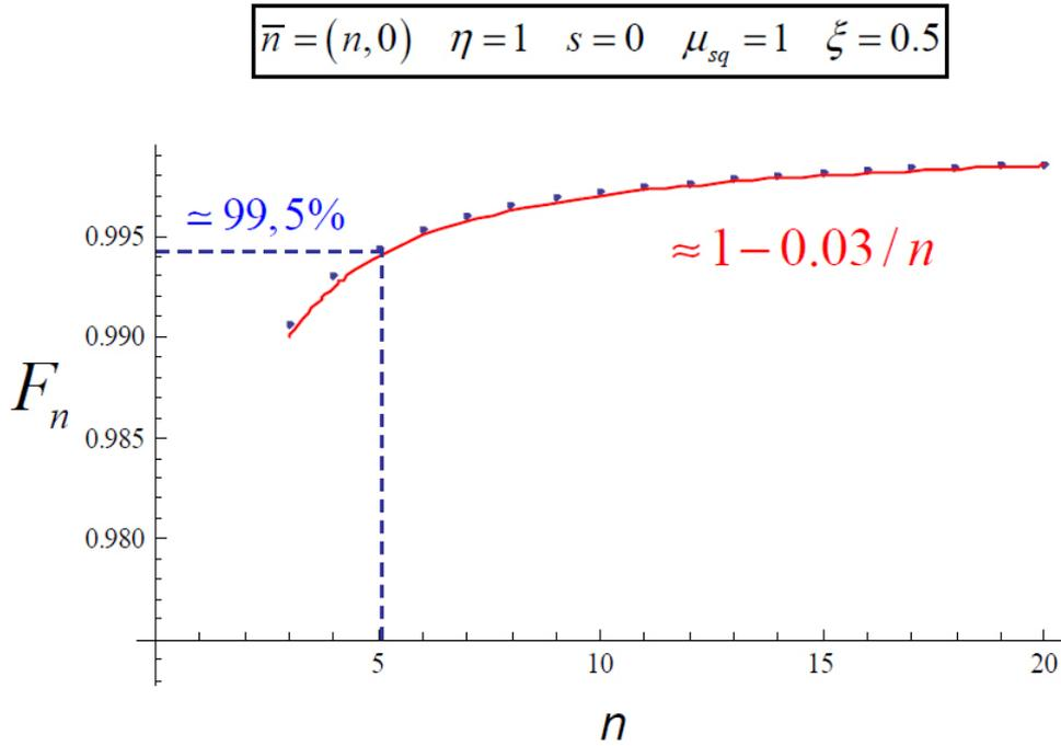
**Figure 6.5:** Évolution de la fidélité entre l'état rétrodicté à partir de la réponse  $\bar{n}$  du DCSL et un état cible d'amplitude  $|\alpha|^2 = n$  et comprimé de  $\xi = 1/2$ . – Pour des nombres de photons  $n \geq 3$ , la fidélité (en bleu) est bien ajustée par  $F_n \simeq 1 - 0.03/n$  (en rouge).
