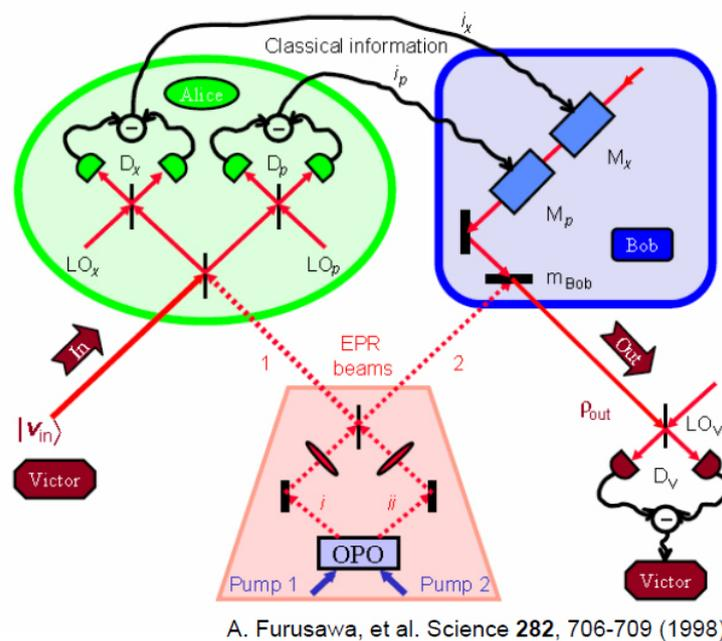
**Figure 6.10:** Protocole de téléportation quantique en variables continues. Extrait de [100]. – Alice réalise deux détections homodynes en quadratures et transmet les résultats à Bob. Ce dernier effectue à partir de ces résultats des modulations d'amplitude (AM) et de phase (PM) sur le faisceau pour le retrouver idéalement dans l'état à téléporter.
