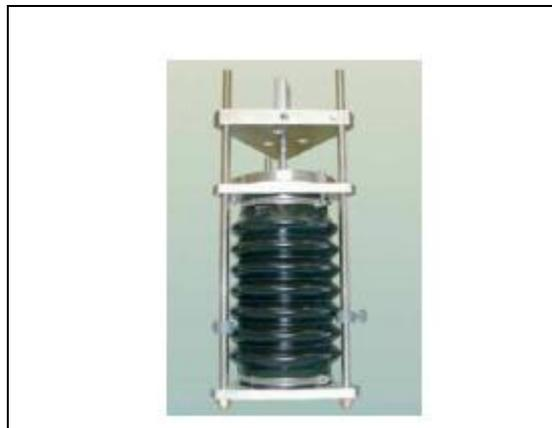
Figure I-40 : Dispositif expérimental de retrait linéique vertical [Boulay, 07]
