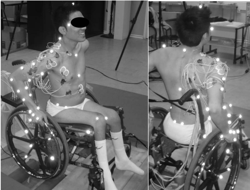
Figure 22 : Sujet paraplégique équipé des électrodes et des marqueurs passifs du Vicon.
