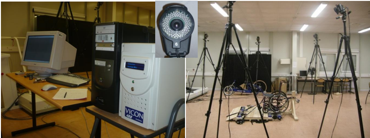
Figure 19: Le système vicon : unité d'acquisition, détail d'une caméra et zone de mesure.
