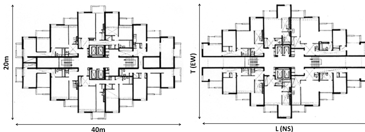
Figure 3.2 – Section transversale des tours : étages pairs(Gauche), étages impairs(Droite)
