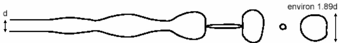
**Figure 14 :** Schéma de brisure d'un jet de type Plateau-Rayleigh
