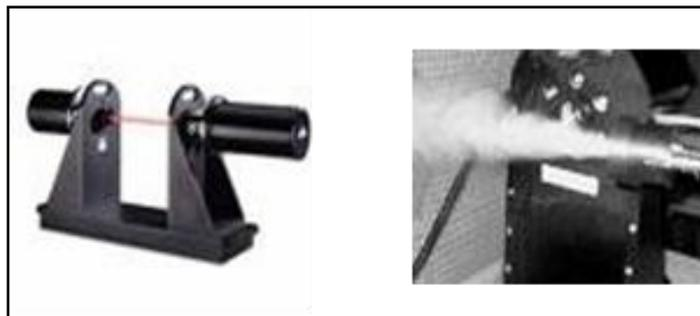
**Figure 39 :** photos a) du Spraytec, b) d'un spray pendant analyse
