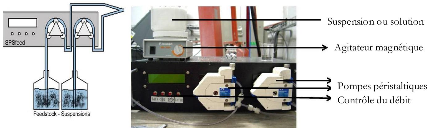
**Figure 12** : Système d'injection par pompes péristaltiques proposé par Pawlowski et al. [13]
