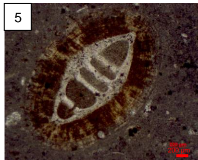
5. Ooïde laminée ferrugineuse avec pour nucleus Lenticulina sp. (Voi46, niveau ferrugineux du sommet des Calcaires à astartes)
