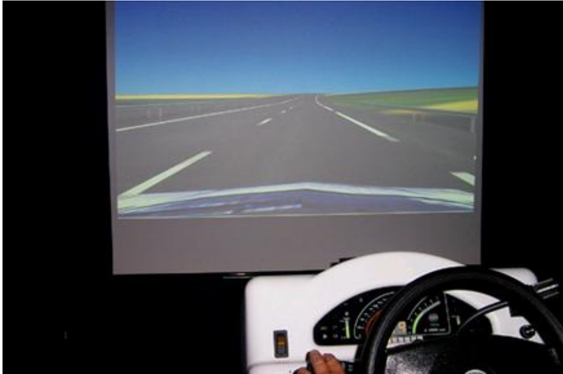
Photographie 1 : Aperçu de l'habitacle du simulateur et de l'écran sur lequel sont projetées les images de synthèse.
