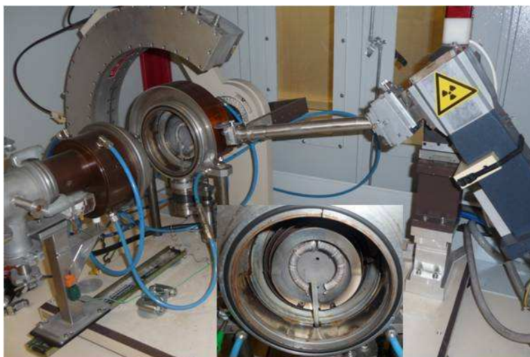
Figure 11 : Four de Thermodiffraction X à la longueur d'onde du cobalt ( \lambda = 1.78897 \text{ \AA} ).
