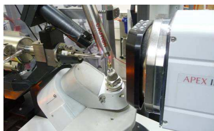
Figure 12 : Diffractomètre Kappa-CCD à quatre cercles muni du cryosystème Oxford .
