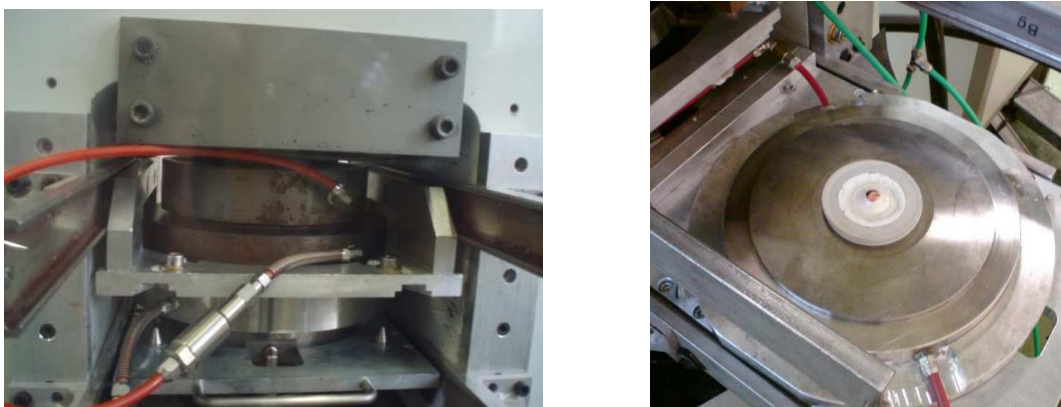
Figure 6 : Photographies du système Conac 40 avec joint de calcite constituant cellule HP.
