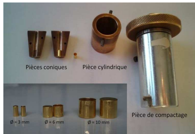
Figure 3 : Outillage de remplissage d'une capsule et capsules de différents diamètres (3, 6 et 10 mm).
