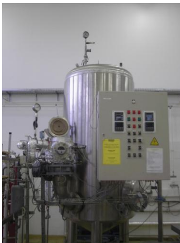
Figure II-1-1. Réacteur de traitement DIC (MP). On y distingue les principales parties qui le composent.
