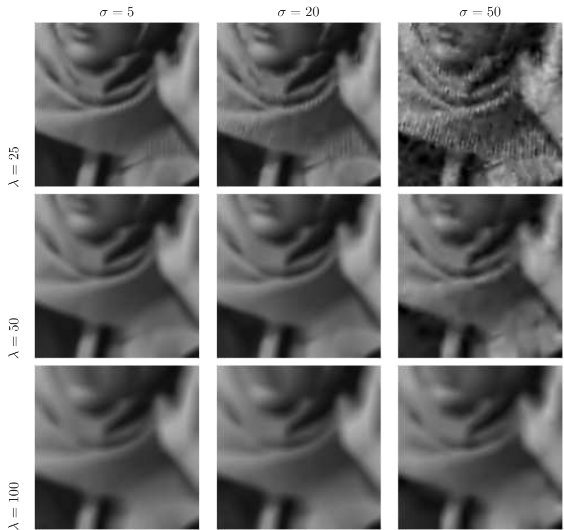
FIG. V.8 – Influence de \lambda (B-2). Les observations sont identiques à celles de la figure V.6. On observe de plus que la texture disparaît totalement à partir de \lambda = 50 .
