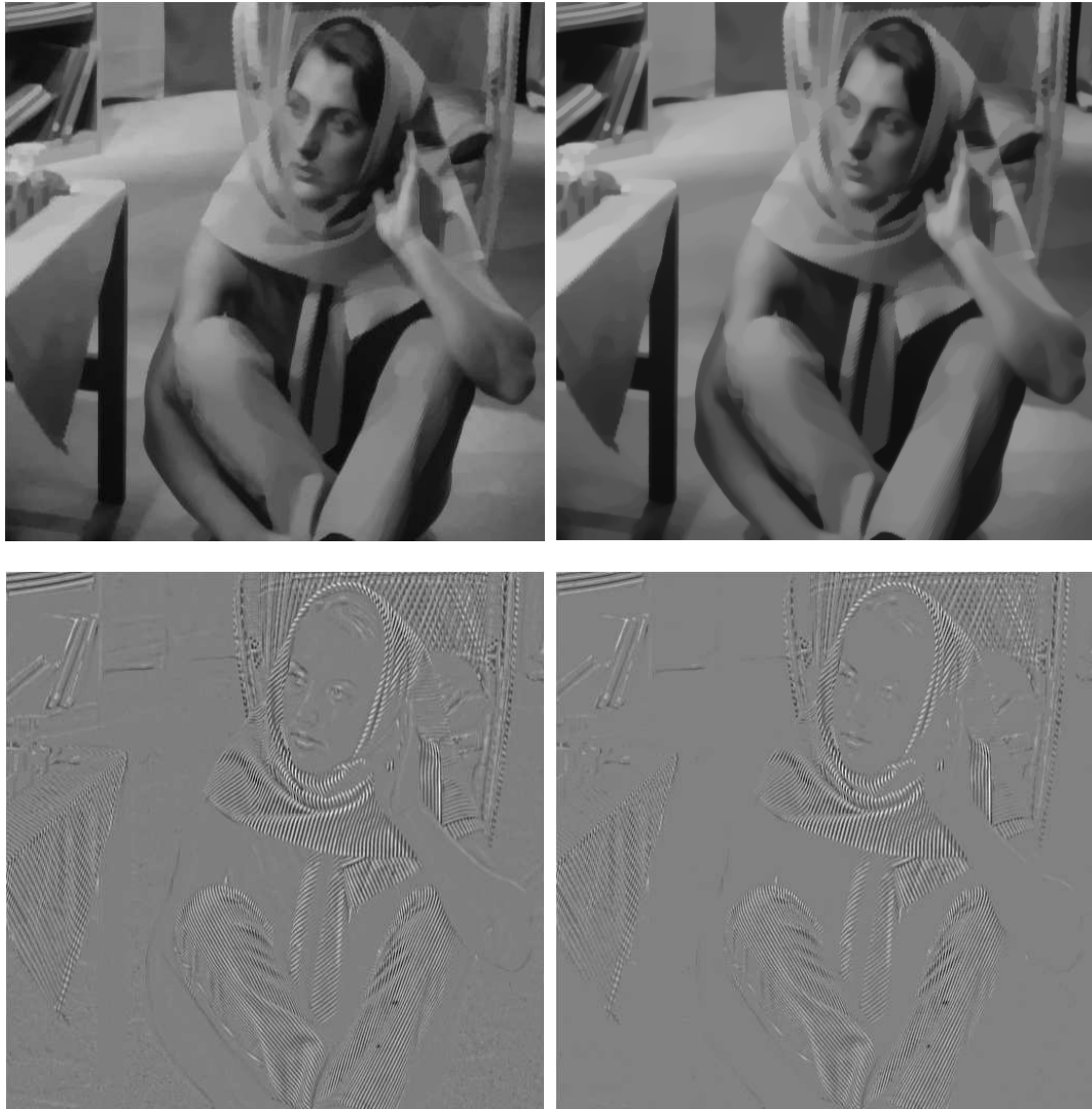
FIG. V.44 – A gauche : Le modèle TV-L^1 . A droite : Le modèle TV-L^1 avec terme d'attache aux données L^2 . \lambda = 30 , \mu = 15 . On observe que pour deux composantes “cartoon” équivalentes, la partie “texture” de l'image obtenue avec le modèle possédant le terme d'attache aux données L^2 contient moins de détails “parasites” (pied de table, visage, bras).
