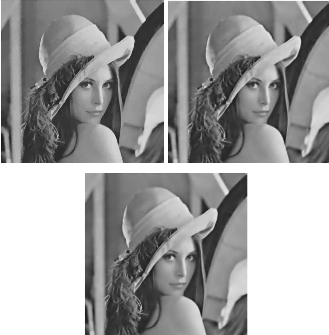
FIG. V.30 – Tests sur l'image complète. De haut en bas et de gauche à droite : ROF (SNR=25.4147), ROF2 (SNR=24.9550), mixte (SNR=25.0423).
