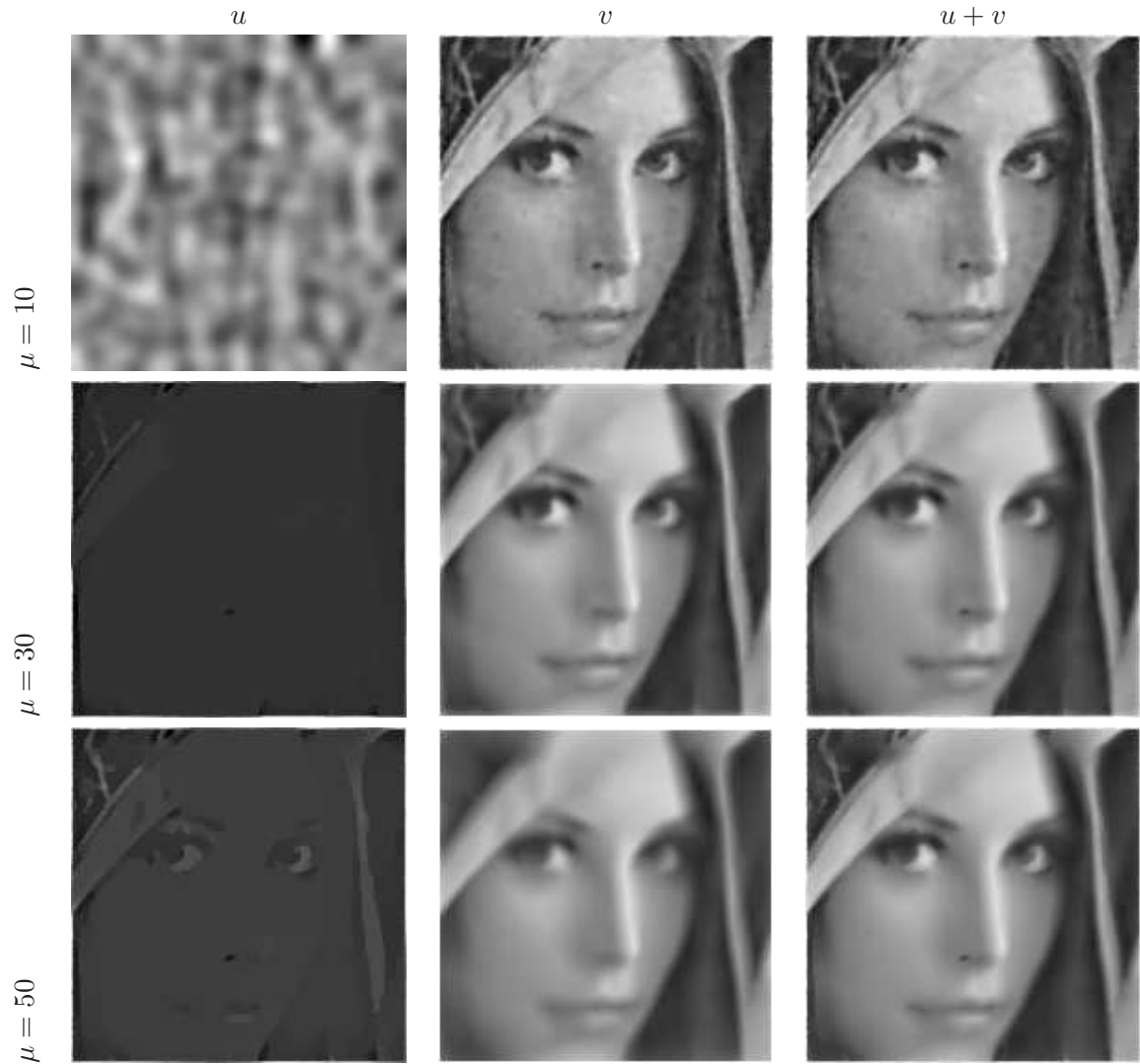
FIG. V.22 – Influence de \mu (B-1). \sigma = 20 et \lambda = 30 . Les observations sont identiques à celles de la figure V.19 à ceci près que l'information commence à apparaître dans la composante u pour des valeurs de \mu plus élevées.
