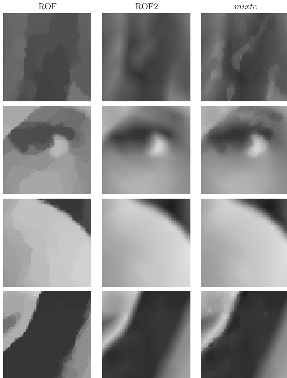
FIG. V.33 – Comme pour l'image précédente, le modèle mixte semble être un bon compromis entre le modèle ROF et le modèle ROF2 : zones homogènes bien lissées et bonne conservation des détails.
