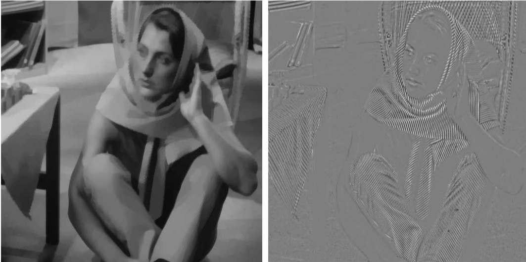
FIG. IV.1 – Modèle TV-L^1 , \lambda = 30 , \mu = 15 . La composante u est à gauche, la composante v à droite.
