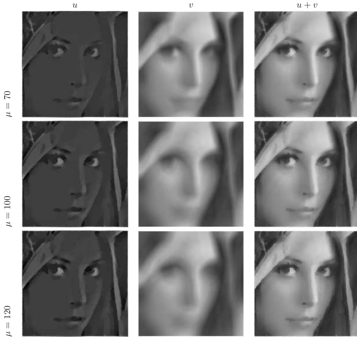
FIG. V.23 – Influence de \mu (B-2). \sigma = 20 et \lambda = 30 . Comparativement à la figure V.20, nous sommes obligés de prendre des valeurs de \mu beaucoup plus importantes pour obtenir des résultats équivalents. De plus, pour \mu = 120 , il semblerait que l'image restaurée u+v commence à devenir constante par morceaux.
