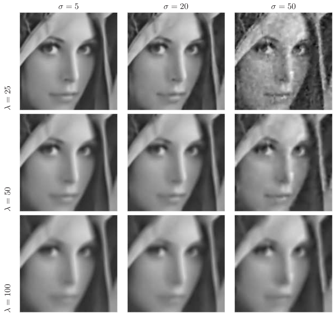
FIG. V.6 – Influence de \lambda (A-2). Une fois le bruit éliminé, l'image devient de plus en plus floue et les détails (tels que ceux du visage) commencent à disparaître.
