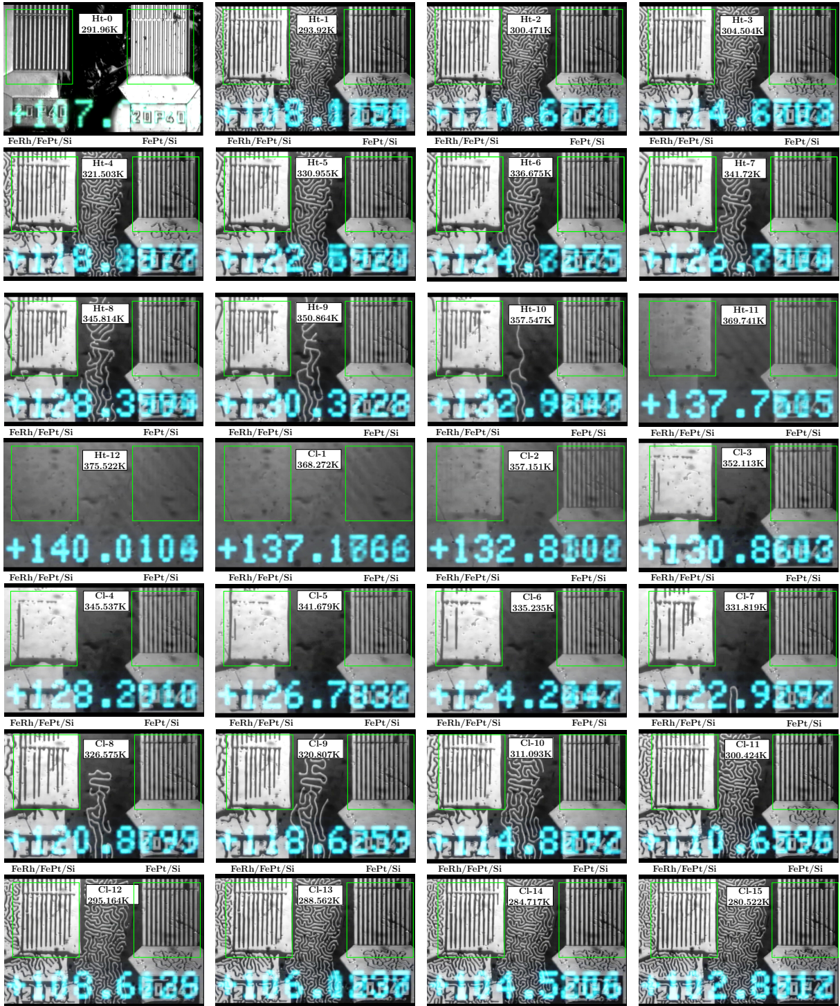
FIGURE III.25 – Série d’images magnéto-optiques d’un caisson 20P40 du système hybride (à gauche) et d’un 20P40 du FePt seul (à droite). Les chiffres en bleu désignent la valeur de la résistance Pt - 100 utilisée pour mesurer la température (chiffes en noirs).
