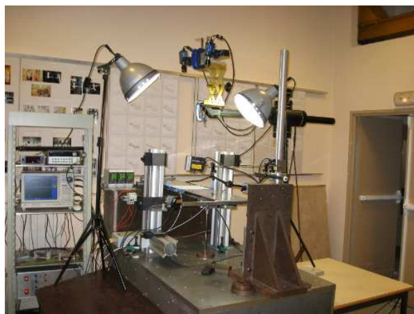
FIGURE 5.21 – Montage expérimental avec les caméras et les autres accessoires pour la mesure de la déformation de la poutre par une méthode de corrélation d'images
