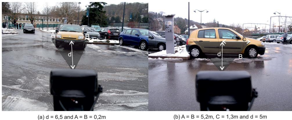
FIGURE 3.32: Détection d'une voiture
