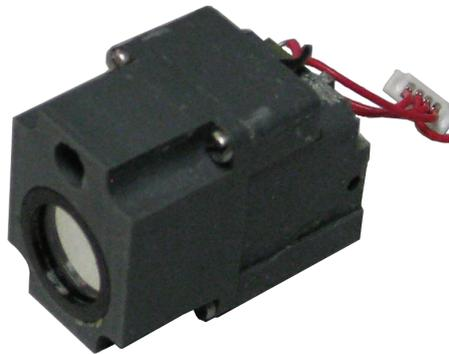
FIGURE 4.15: Image réelle de la tête optique
