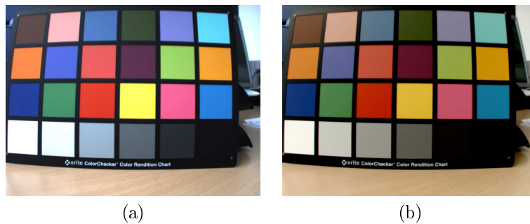
FIG. 4.17 – Scène de test : acquisition à 20 ms (a) et log-luminance obtenue avec notre méthode (b).
