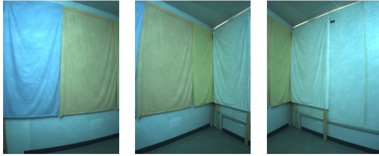
FIG. 3.36 – Acquisition d’images avec recouvrement pour la correction de vignetage.
