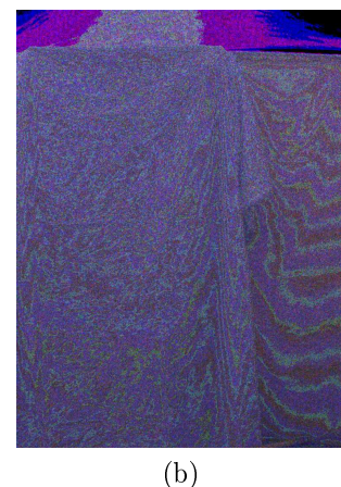
FIG. 3.11 – Bruit de mesure de la caméra : écart-type absolu du pixel test (a) et écart-type absolu (amplifié) de tous les pixels à 40 000 \mu s (la valeur pour un canal est représentée dans la couleur du canal) (b).
