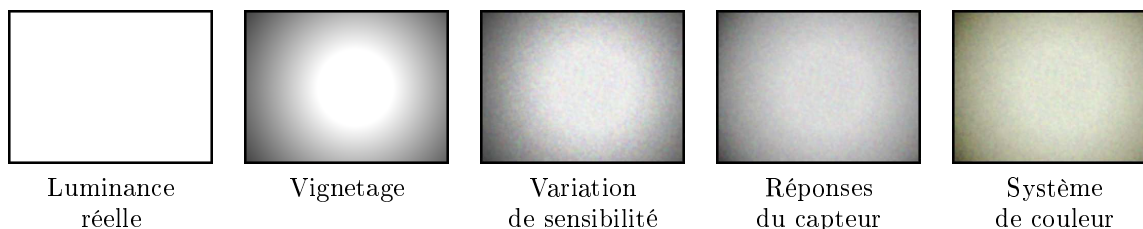
FIG. 4.1 – Caractéristiques du modèle radiométrique de la caméra.
