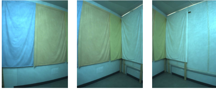
FIG. 3.36 – Acquisition d’images avec recouvrement pour la correction de vignetage.
