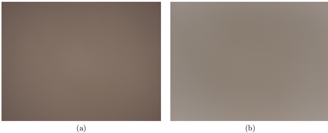
FIG. 4.16 – Correction de la variation de sensibilité et du vignetage : log-luminance non corrigée (a) et log-luminance corrigée (b).
