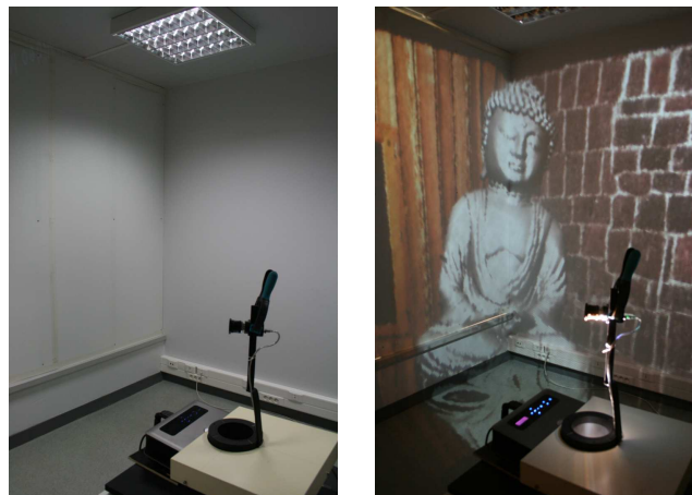
FIG. 10.4 – Réalité mixte : pièce réelle (à gauche) et scène de réalité mixte avec des matériaux modifiés, un objet virtuel et une source de lumière virtuelle (à droite).
