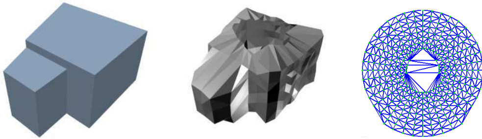
FIG. 10.1 – Reconstruction géométrique de la pièce réelle : pièce réelle reconstruite manuellement (à gauche), pièce reconstruite par le système (au milieu) et maillage correspondant dans l’image projecteur (à droite). Images fournies par Henri Astre.
