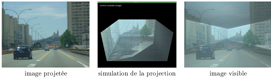
FIG. 6.20 – Simulation des transfert d'énergie (projection, réflexions multiples, acquisition caméra).
