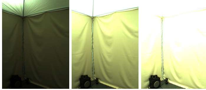
FIG. 3.43 – Acquisition d'une scène fixe avec une caméra mvBlueFox121-C à 50\,000\mu s , 200\,000\mu s et 400\,000\mu s .
