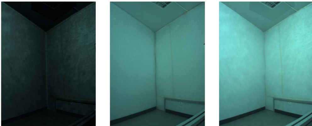
FIG. 6.10 – Séparation de l'éclairage réfléchi directement (gauche) et de l'éclairage réfléchi indirectement (milieu) d'une scène réelle (droite).
