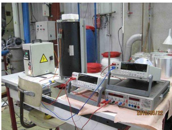
Figure II.17. Dispositif de mesure de la conductivité.
