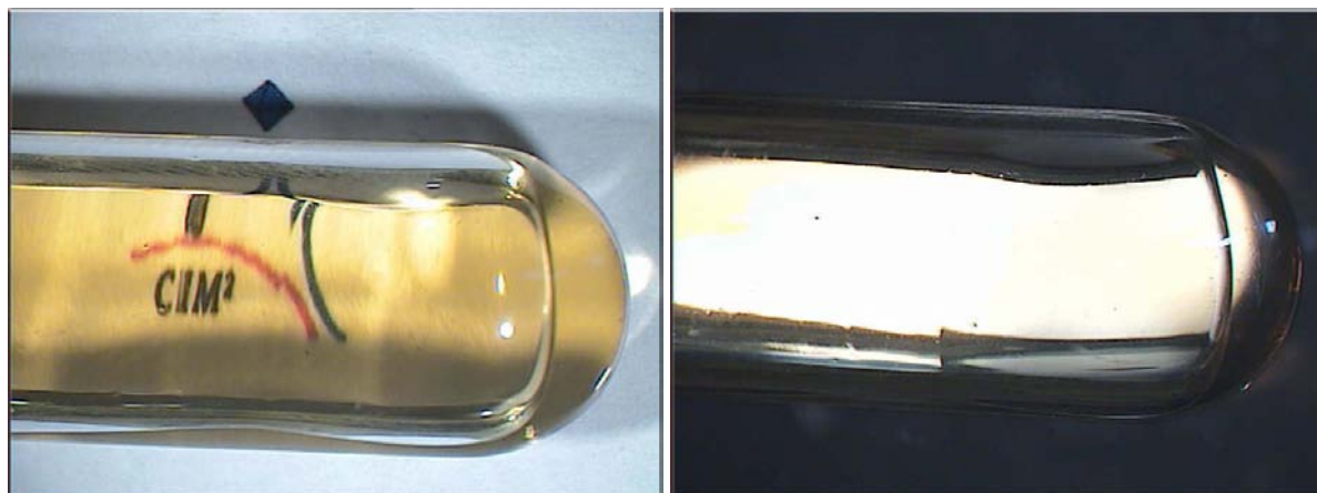
Fig. 4.9. Photographies du gel formé par [PdCl_2(MnMo_6O_{18}\{(OCH_2)_3CNHCO-4-pyr\}_2)]_n^{3n-} . A gauche : lumière normale ; à droite : polariseurs croisés.
