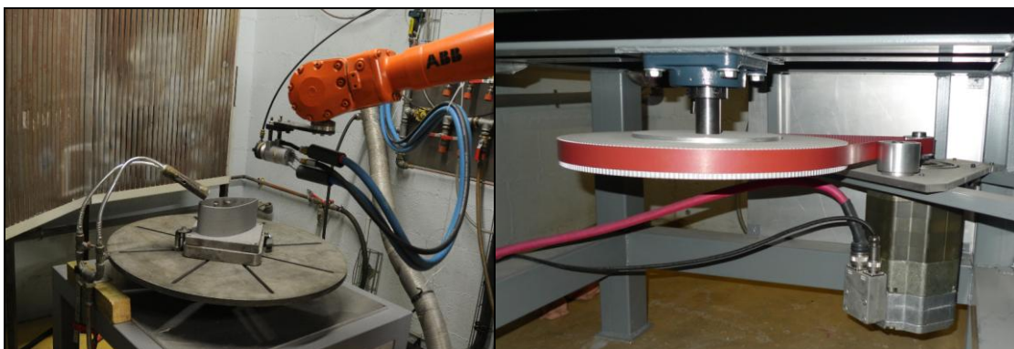
Figure 4.16 Robot IRB 2400/16 muni d'une torche F4 et l'axe externe
