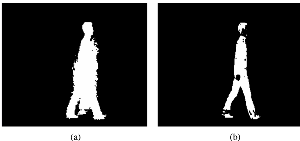
fig. 4.4 : Exemple d'utilisation d'un filtre HSV ; (a) En utilisant un seuil d'une petite valeur pour la différenciation des images courante et de référence, nous pouvons introduire de l'ombre dans l'image 'silhouette' obtenue. (b) Par application d'un filtre de type HSV, nous remarquons que les ombres sont effacées.
