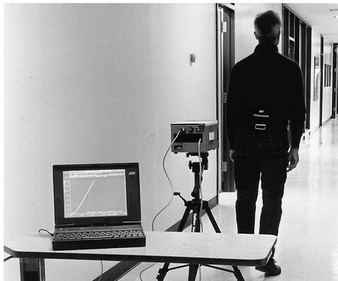
**fig. 2.9 :** Télémètre à ultrasons utilisé pour mesurer la vitesse instantanée et la fréquence de pas d'une personne.
