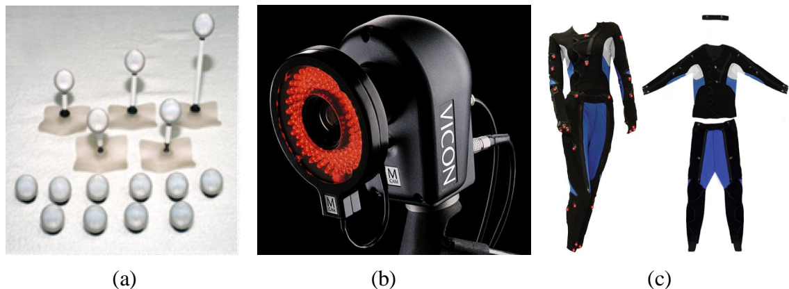
fig. 2.10 : (a) marqueurs lumino - réfléchissants utilisés dans les systèmes dits 'passifs' ; (b) Caméra Vicon® équipée d'un émetteur/récepteur infrarouge ; (c) marqueurs 'actifs' (LED) fixés sur une combinaison pour le système Visualeyze®
