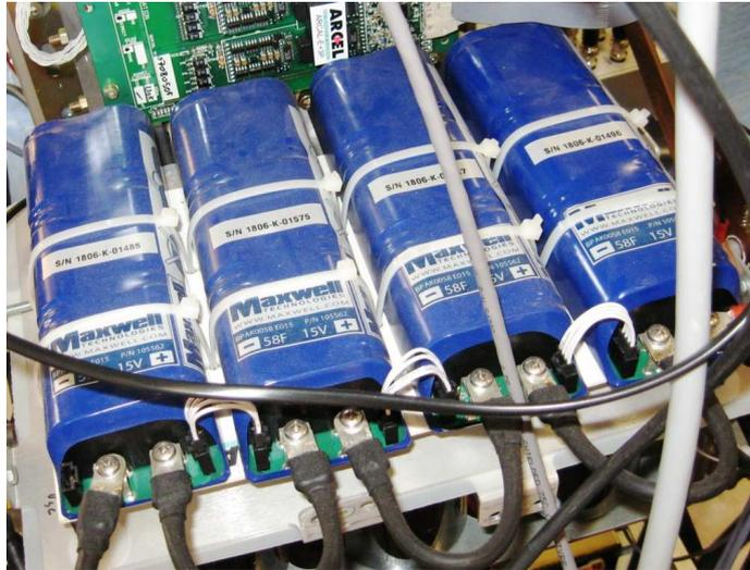
FIGURE 28. Supercondensateurs
