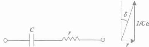
Fig. 5. 18 : Modèle représentant les pertes du diélectrique d'un condensateur
