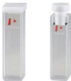
*Figure VI.1 : Cuves en quartz*
