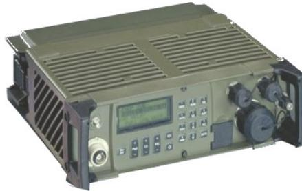
Figure 4.10 – Photographie d'un poste radio de quatrième génération (PR4G) développé par Thalès Communications pour l'armée française.
