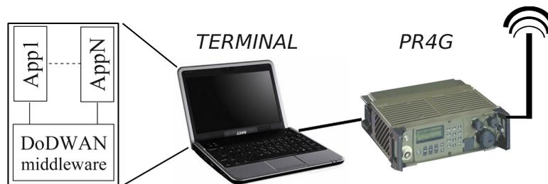
Figure 4.13: Architecture d'une unité mobile utilisée lors de nos expérimentations sur des postes radio de combat (PR4G).
