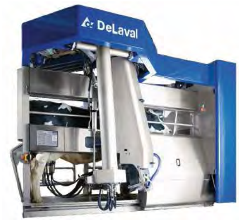
Photographie 1 : Robot de traite DeLaval VMS 2007. Sources : www.delavalfrance.fr
