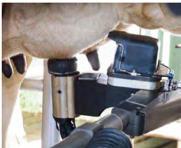
Photographie 3 : Système de nettoyage des trayons du robot DeLaval VMS 2007 (gobelet laveur). Sources : www.delavalfrance.fr
