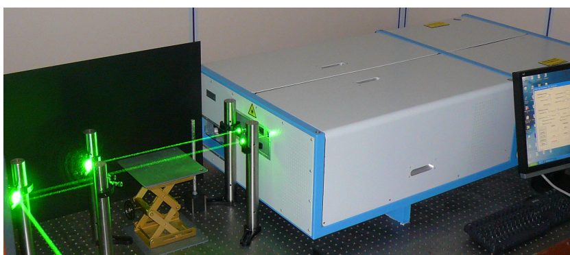
FIGURE IV.8: Photo du laser de pompage Nd :Yag.
