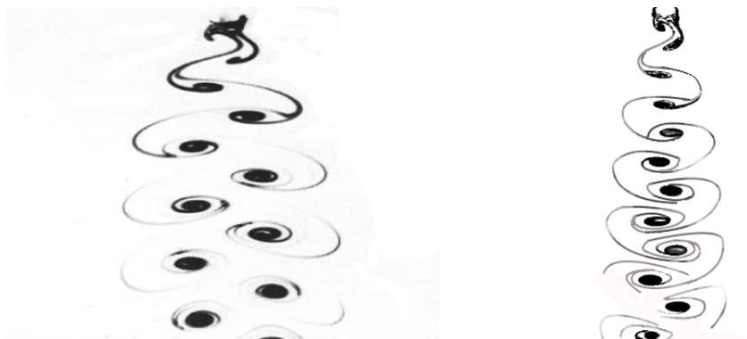
FIGURE 1.2 – Représentation de l’allée produite par un tourbillon. L’image de gauche est issue d’un cas expérimental tandis celle de droite est le résultat d’une simulation de MFN. (<http://www.mathematik.uni-dortmund.de>)
