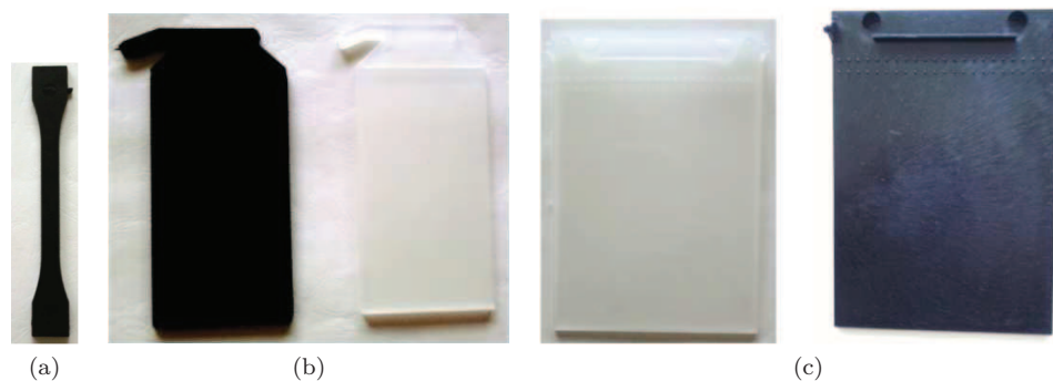
FIGURE 4.1: Vue de dessus des différentes éprouvettes à base de PP et de mélange PP/GTR, a) Traction b) Choc c) Calepin (acoustique)
