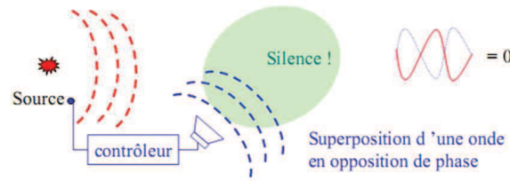
FIGURE 1.22: Absorption acoustique par contrôle actif
