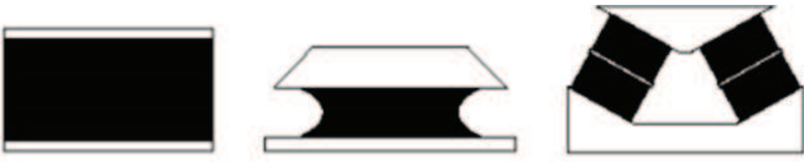
FIGURE 1.26: Exemples d'isolants vibratoires : en noir le polymère, les parties blanches indiquant les parties métalliques
