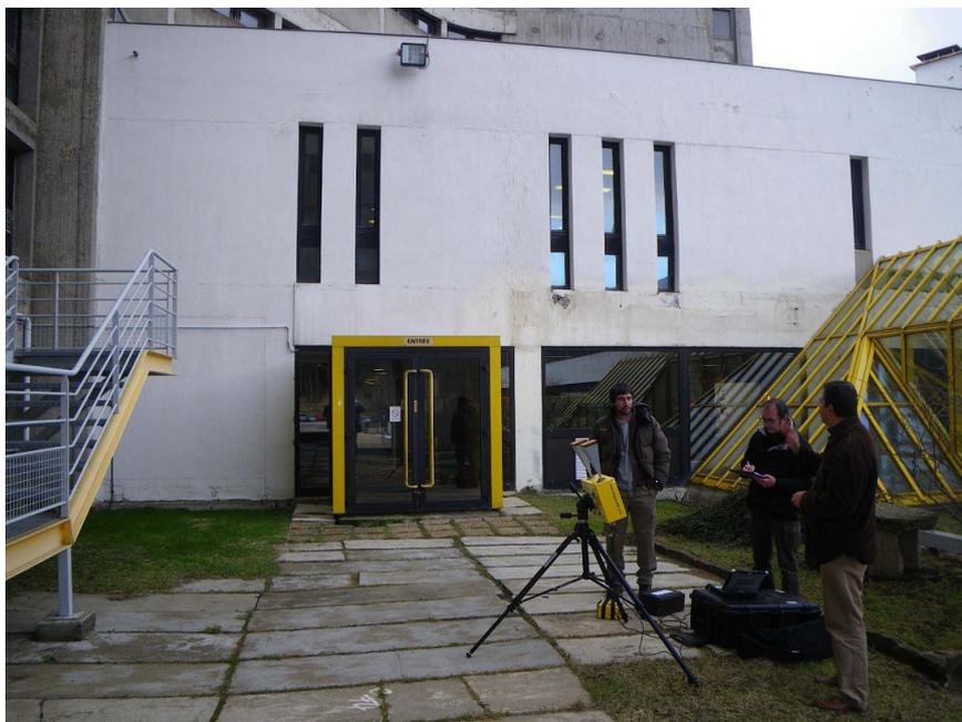
FIGURE 23 – Mesure vibrométrique à partir de radar (bande Ka, échantillonnage 100Hz) sur un bâtiment sur la commune de Font Romeu. Collaboration IG/BRGM)
