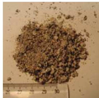
FIGURE 1.5 – Fragmentation d'une roche en laboratoire soumise à une vitesse de déformation de 140 \text{ s}^{-1} [34]
