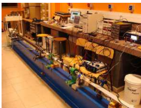
FIGURE 5.3 – Essai d’écaillage aux barres de Hopkinson, test développé au Laboratoire de Physique et Mécanique des Matériaux à Metz, par B. Erzar et P. Forquin [37, 48]
