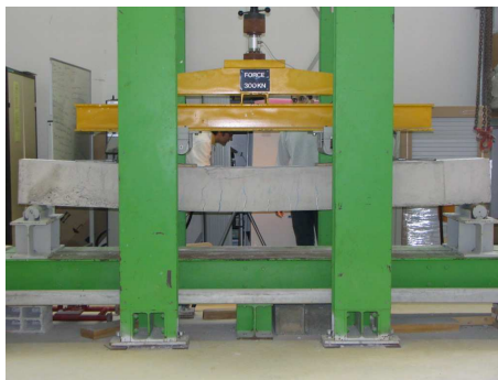
FIGURE 4.9 – Banc de flexion à quatre points du Laboratoire de Mécanique et Matériaux du génie civil de l'université de Cergy-Pontoise
