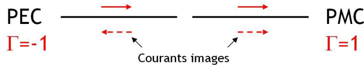
FIGURE 1.38 – Fil parcouru par un courant sur des surfaces PEC et PMC.
