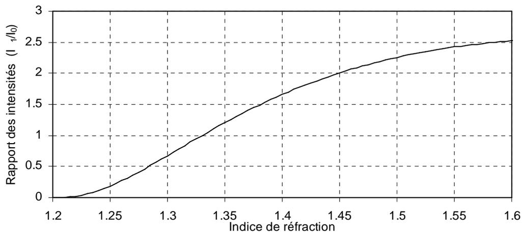
*Fig 15. Evolution du rapport d'intensité en fonction de l'indice de réfraction par l'optique géométrique pour  $\theta=66.785^\circ$*
